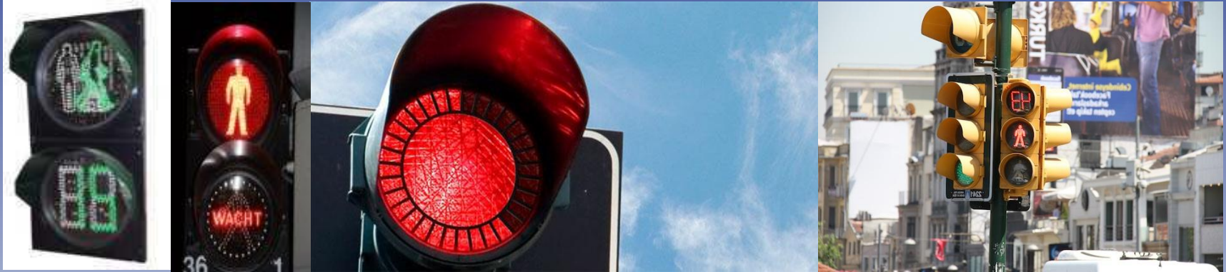
Različita rješenja prometnog svjetla sa „brojačem“ faze prometnog svjetla na pješačkom prijelazu
